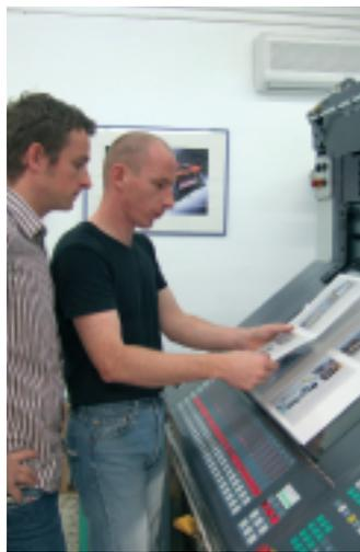
Als gelernter Drucker war Sebastian Keuck, wie er selbst sagt, gespannt wie ein Flitzbogen, wie sich die prozesslose Platte im Druckalltag bewährt. »Nach 10 bis 15 Bogen sind wir in Farbe.« Die Schicht der prozesslosen Platte löst sich während der Anfahrssequenz der Druckmaschine und wird über die Makulaturbogen entsorgt.
