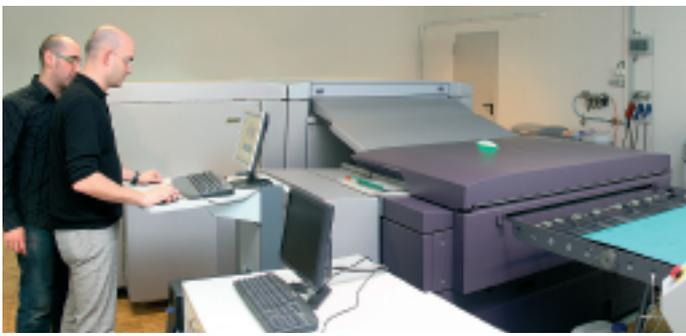
Für die Ende März 2006 in Betrieb genommene neue KODAK-CTP-Linie wurde der Druckvorstufenabteilung mehr Raum gegeben. Der Kodak Magnus 800 Quantum übergibt die bebilderten Druckplatten an eine Kodak Mercury-Plattenverarbeitungsanlage.
