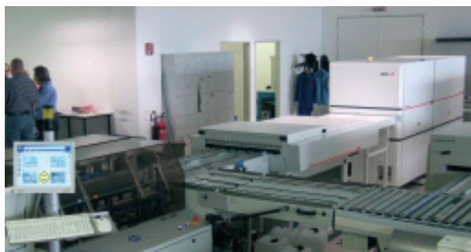
Nur ein Ausschnitt der CtP-Installation bei MediaPrint: auf dem Agfa Advantage wird die chemiefreie Agfa »Chemfree Polymer Violet« belichtet.
