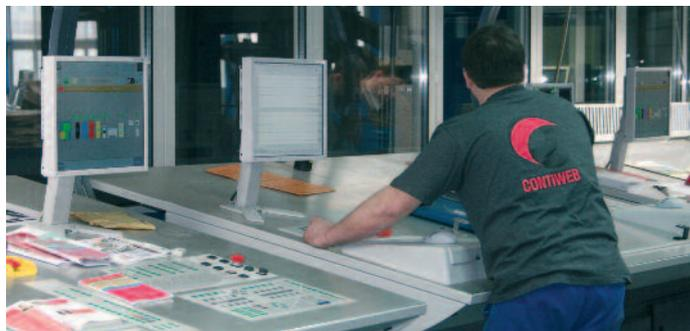
Über JDF sind sämtliche druckrelevanten Daten im PECOM-System vorhanden. Hier ersichtlich die Papierqualität, Grammatik und Bahnbreite (äußere Farbzonen sind bereits automatisch geschlossen – in Bezug auf die Bahnbreite). Mit Hilfe der JDF-Voreinstellendaten wird die Rotation bei Folgeformen in nur 15 Minuten wieder auf Produktion gebracht.
