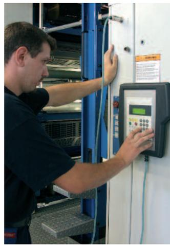
Jede der kompakten »Eins für zwei«-Reinigungseinheiten der Baldwin Oxy-Dry-Gummituchwaschanlage reinigt in den Achtertürmen simultan zwei übereinander angeordnete Gummitücher. In der herausgenommenen Einheit ist die Bürste erkennbar. Zustand und Funktionen der lokale Steuerung und der Baldwin Oxy-Dry-Reinigungseinheiten in den Drucktürmen lassen sich mit einem mobilen Diagnosegerät überwachen.
