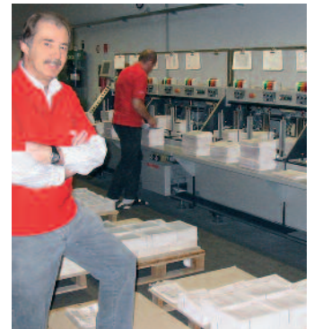
Das CAB-System (hier der Klebebinder SB-09, der mit dem PUR-Klebebindungsverfahren arbeitet) kommt auf eine Leistung von bis zu 4.000 Takten in der Stunde. Günter (vorne) und Gerhard Rudenko loben die Horizon-Bindestraße CAB 4000: Sie arbeitet ohne Fehl und Tadel.
