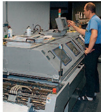
Das CAB-System (hier der Klebebinder SB-09, der mit dem PUR-Klebebindungsverfahren arbeitet) kommt auf eine Leistung von bis zu 4.000 Takten in der Stunde. Günter (vorne) und Gerhard Rudenko loben die Horizon-Bindestraße CAB 4000: Sie arbeitet ohne Fehl und Tadel.
