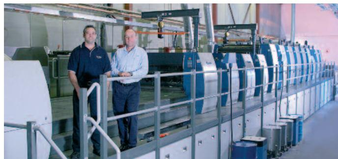
Eine der längsten Installationen im Großformat ist die rund 40 m lange Rapida 142 mit 13 Druck-, Lack und Trockenwerken bei Anzpac im australischen Sydney.
