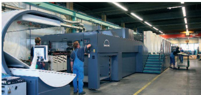
Eine Roland 900 XXL der Superlative: 200 Tonnen Stahl, was dem Gewicht von 135 VW Golf entspricht, und 20.000 verarbeitete Einzelteile verteilen sich auf 35 m Länge. Hier die Maschine für den US-Mediendienstleister Schawk in den USA bei der Montage im MAN Roland Werk Mainhausen.
