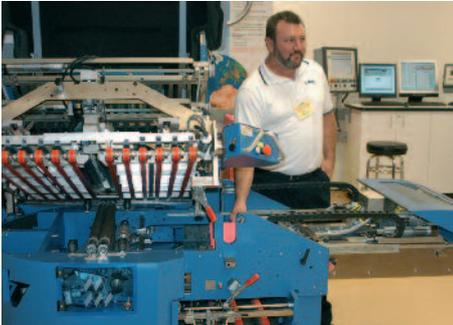
Die Kombi-Falzmaschine K800 Super-KTZ: Je nach Bedarf kann die schwenkbare Dreibruch-Schwerteinheit am linken oder rechten Maschinenausgang positioniert werden.
