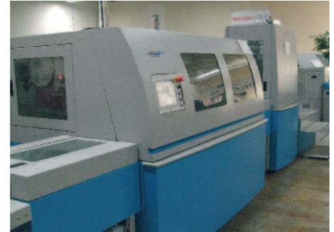
Beispiel aus der Praxis (unten): Eine der Verarbeitungslinien bei Vertis mit Komponenten von MBO, Ehret und Palamides. Hier werden Rollen im Offset vorgedruckt, im Digitaldruck personalisiert und danach verarbeitet. Vertis ist spezialisiert auf die Mailing-Verarbeitung mit Web-Inline-Lösungen.
