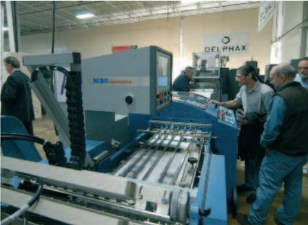
160 Seiten, digital auf einer Delphax-Maschine gedruckt, inline geschnitten und gefalzt, als Block transportiert und in der Müller Martini Sigma Klebebinde-Linie fertiggestellt – Digitaldruck-Produktion im Sekundentakt.
