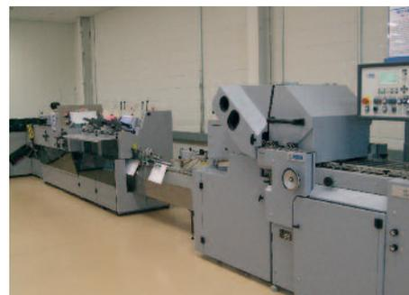
MBO hat in Zusammenarbeit mit Hohner den Digi-Finisher entwickelt. Der Vorteil: Falzen und Sammelheften erledigt er in einem Arbeitsgang.
