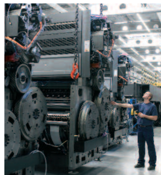
Zur drupa 2008 stellt Heidelberg eine neue Bogenstanze mit den Funktionen Stanzen, Ausbrechen und Nutzentrennen vor, die im Format auf die Speedmaster XL 145 abgestimmt ist.
