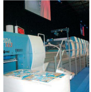
sätzlich vor der Bogenwendung jeden Bogen bei maximaler Geschwindigkeit mit einem Revisionsbogen vergleicht.
