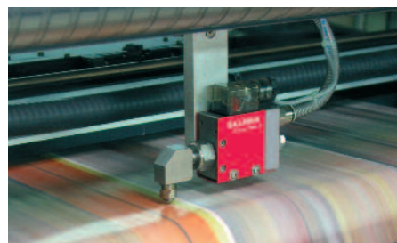
Mit WebTack präsentiert Baldwin für den Akzidenzrollenoffsetdruck ein Längsleimsystem.
