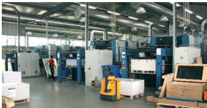
Blick über drei von insgesamt zehn Bogenoffsetmaschinen im 6er-Maschinenformat, die das Druckhaus Mainfranken derzeit im Einsatz hat.
