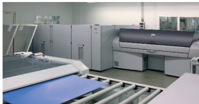
Im Werk Klipphausen bebildern zwei parallel angeordnete CTP-Linien von Kodak mit einander entgegengesetztem Materialfluss ungefähr 1.200 Druckplatten pro Tag.
