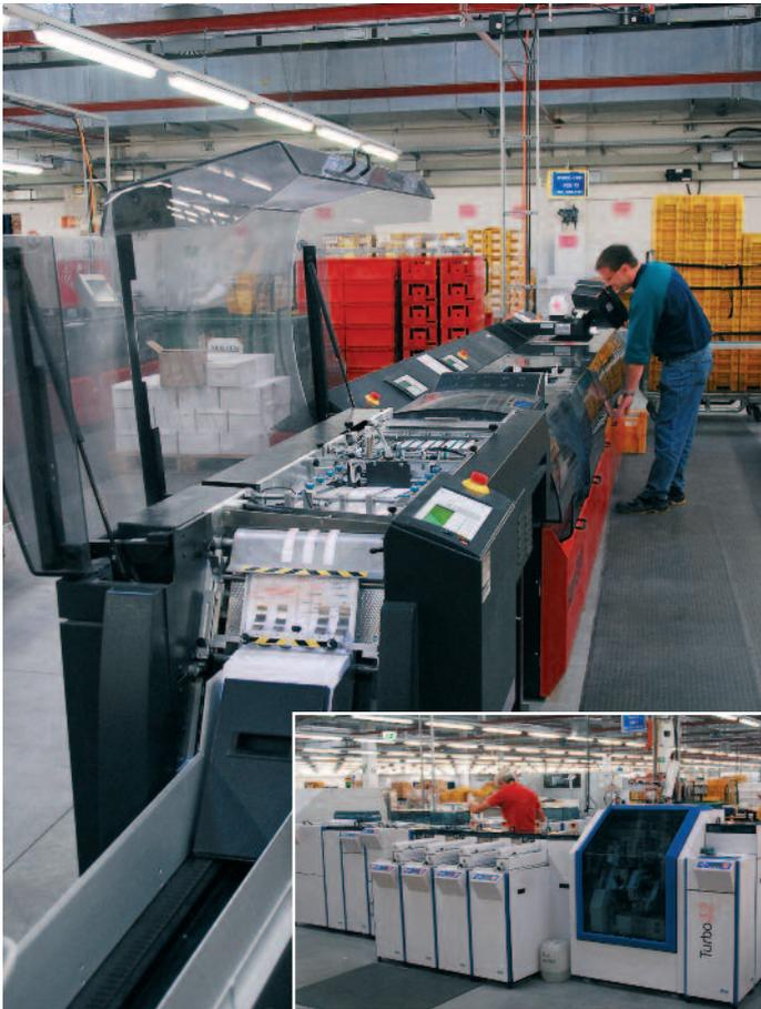
High-Speed-Kuvertiersysteme – hier Modelle von Kern (großes Bild) oder von Boewe – schaffen leicht 22.000 Kuvertierungen pro Stunde.
