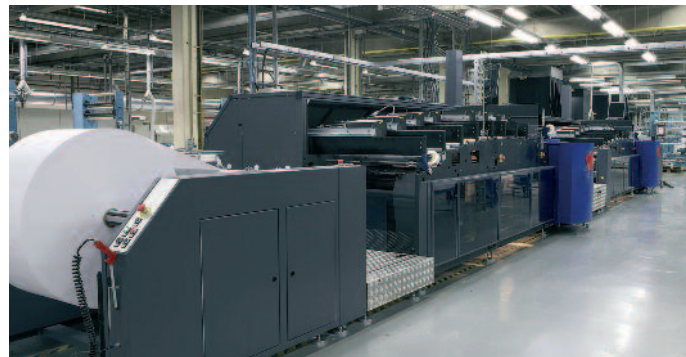
Das Matti-Transportsystem, auf dem die Kodak-Versamark-Druckköpfe für vollfarbigen Druck installiert sind.
