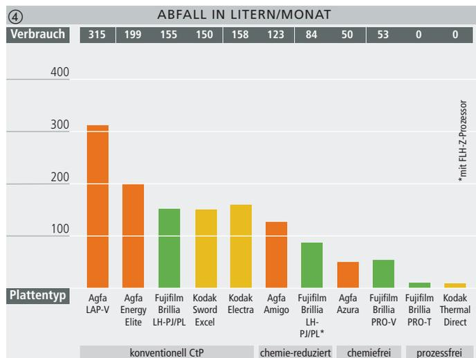
aus, das dazu beiträgt, den Chemikalienverbrauch zu reduzieren. Es gibt diverse Optionen zur Senkung des Chemikalienverbrauchs wie den Prozessor Fujifilm FLH-Z ZAC bei der Brillia HD LH-PJ/PL oder die Verwendung von Druckplatten mit reduziertem Chemikalienverbrauch wie die Amigo von Agfa.
