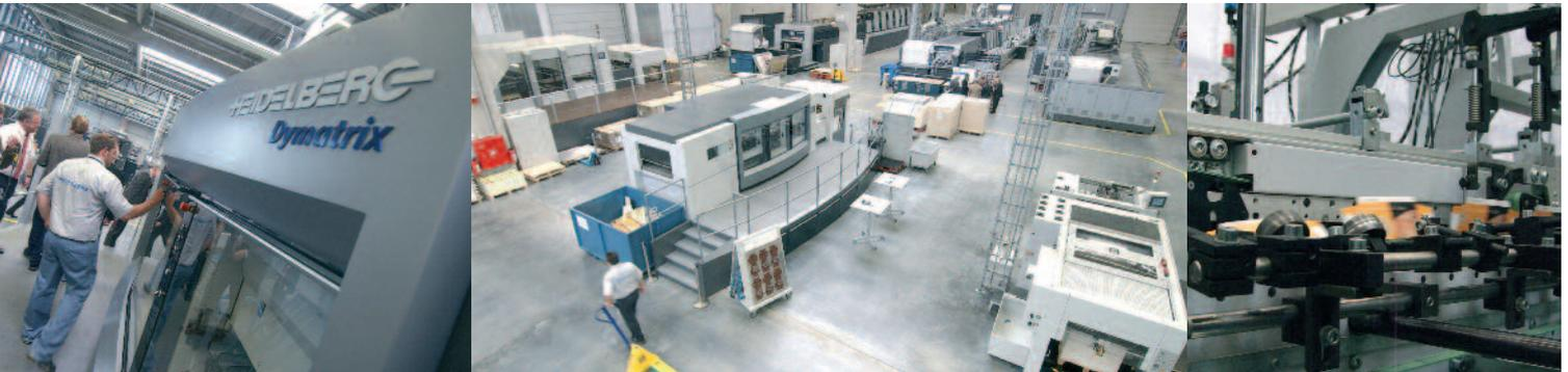
spezifische Anforderungen konfiguriert werden können. Mit dem optionalen Diana Feeder und Packer kann die Maschine bis zu 200.000 Faltschachteln pro Stunde produzieren und verpacken.
