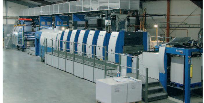
Das Vinfoil-System ist auf einer Ebene mit dem Leitstand der KBA Rapida 106 angeordnet und ermöglicht den fliegenden Rollenwechsel. Oberhalb der Druckwerke der Überbau zur Zuführung und Entsorgung der Folie.
