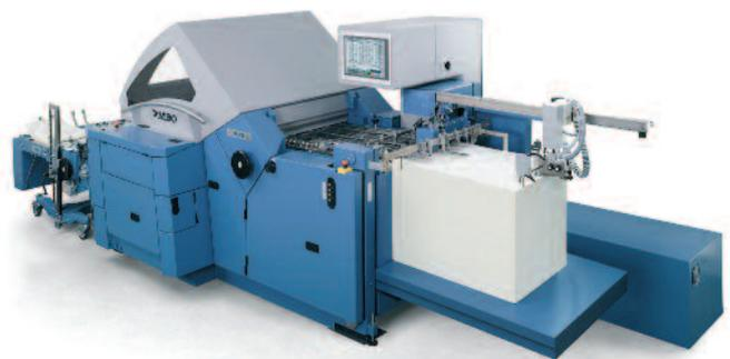
**Völlig neu konstruiert: Die Kombifalzmaschine K 765 Efficiency Automatic von MBO vereint Automatisierung und stabile Bauweise. Gleichzeitig ist sie die leiseste Maschine der Welt in ihrer Formatklasse: Sie ist vollgekapselt. Selbst die Papier-Ausläufe sind nur schmale Schlitz (im Bild unten), die sich bei Bedarf für Wartungsarbeiten weiter öffnen lassen.**
