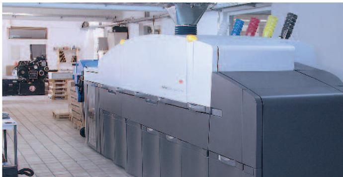
Jede der beiden Nexpress Druckmaschinen druckt im Monatsdurchschnitt bis 700.000 Farbseiten. In Spitzenzeiten erreicht jede bis 1,2 Millionen.
