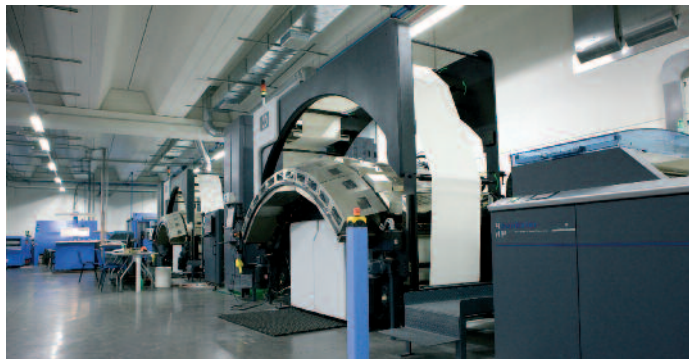
Zusammen mit einem Inline-Finishing-System von Müller Martini bildet die HP T300 Color Inkjet Web Press eine unabhängige Produktionseinheit.
