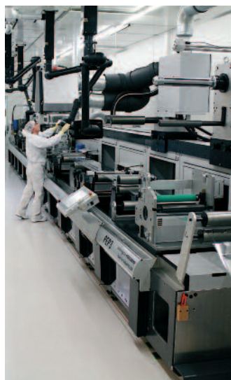
In einem Reinraum des Spitzenclusters Organische Elektronik in Heidelberg wird an einer Rolle-zu-Rolle-Versuchsplattform für gedruckte Elektronik geforscht. Die Maschine stammt von der Heidelberger Druckmaschinen AG.
