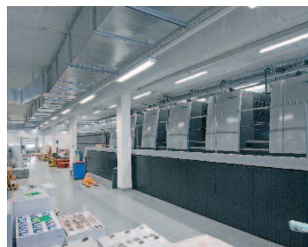
tigen Akzidenzdruck an. Mit der Speedmaster XL 145 entstehen Geschäftsberichte, Kataloge, Magazine, Kalender, Landkarten und Displays.
