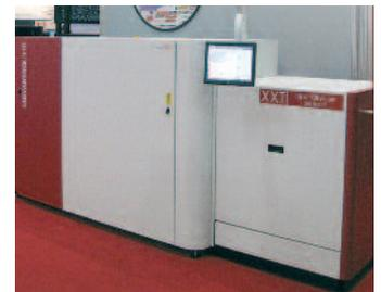
der chemiefreien Photopolymer-Druckplattentechnologie von Agfa und ermöglichte jetzt 30% bis 40% höhere Auflagen (bis zu 200.000 Drucke). Da keine Chemie erforderlich ist, entfallen die mit der Entwicklung verbundenen Variablen, die sich nachteilig auf die Konstanz des Druckbilds auswirken könnten. Stattdessen wird die Druckplatte mit einer pH-neutralen Lösung in der Auswascheinheit oder Clean-Out Unit VXCF85 ausgewaschen, die in ihrer Geschwindigkeit auf den Advantage N-TR XXT abgestimmt ist.
