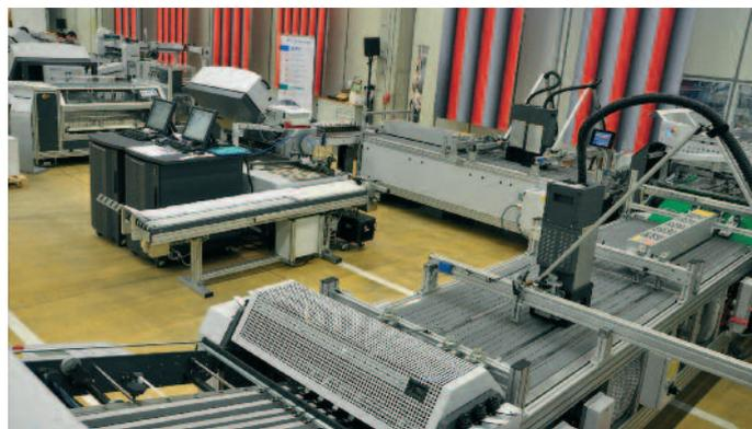
Der Stahlfolder Flexomailer kombiniert Mailingkomponenten der Firma Popp und Inkjet-Technologie von Kodak.
