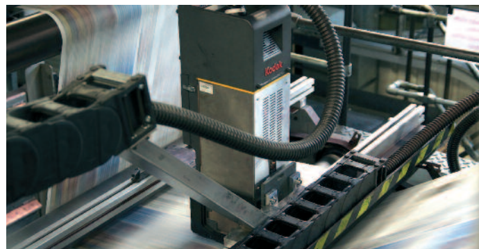
Erhebliche Fortschritte erzielte Kodak bei seinen Eindruckköpfen. Mit dem Prosper S30 werden beim Axel-Springer-Verlag in Ahrensburg in einer Rotation Geschwindigkeiten von 13,2 m/s erreicht.
