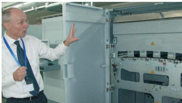
Die Druckeinheit der Océ ColorStream 3700 wirkt sehr aufgeräumt. Mit der Twin-Konfiguration und ihrer Leistung von 100 m/Min. lassen sich rund 80.000 vierfarbige A4-Seiten pro Stunde produzieren.
