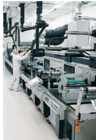
Im Reinraum des Spitzenclusters von BASF, TU Darmstadt und Heidelberg wird an zukünftigen Anwendungen der gedruckten Elektronik auf einer modifizierten Rollendruckmaschine auf Basis einer Gallus RCS 330 gearbeitet.
