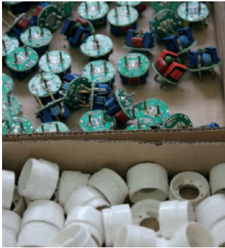
Die Smart Swap besitzt eine eigene, integrierte Vorschaltelctronik.
