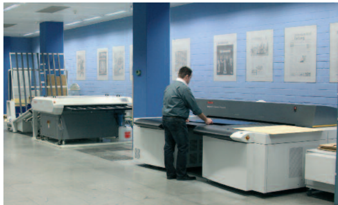
Ein Kodak Magnus VLF 5570 Quantum Plattenbelichter als Halbausomat vervollständigt die CTP-Kapazität und dient als Backup.
