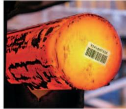
eine Hitzebeständigkeit von bis zu 1.200°C bietet und sich mit variablen Daten bedrucken lässt, löst Probleme, mit denen Hersteller in der
