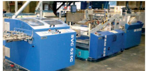
Die neue MBO-Digitallinie, die im Ricoh Document Center in Brackenheim zur Mailingproduktion installiert wurde, besteht aus einem Abwickler, einem Split-und-Merge-Modul und einem Querschneider.
