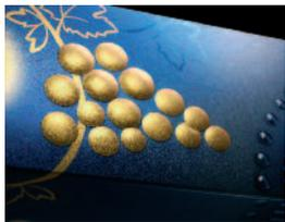
Mit der Sechsfarben-Speedmaster XL 106 mit Doppellack produziert Karl Knauer veredelte Präsentverpackungen mit Matt-Glanz-Varianten und UV-Anwendungen auf Kartonagen zwischen 200 und 600 g/m<sup>2</sup>.
