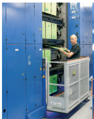
Bestückung der Achtertürme mit den Wasserlos-Druckplatten via Lift.
