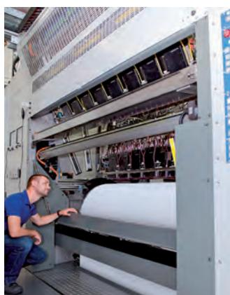
Die von KBA zur WPE vorgestellte RotaJet L-Plattform ist in fünf Bahnbreiten von 895 bis 1.300 mm verfügbar und für wechselnde Marktanforderungen auch bei Druckbreite und Farbigkeit nachrüstbar.
