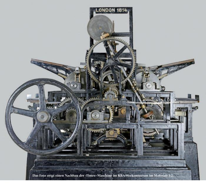
Am 29. November 1814 wurde nach 360 Jahren Gutenberg'scher Handpresse erstmals eine Zeitung auf einer Doppelzylindermaschine mit Dampfmaschinenkraft gedruckt. Die Londoner >Times< nutzte dazu eine Maschine von Friedrich Koenig und Andreas Bauer. Damit feiert der maschinelle Zeitungsdruck 2014 sein 200-jähriges Jubiläum.
