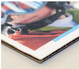
pappen-Top-Liner (Deckkartons, die auf den Wellpappenträger kaschirt werden). Die Maschine soll bis zu 183 m/Min. schnell sein und dabei 27.871 m<sup>2</sup>/h Substrat bedrucken.
