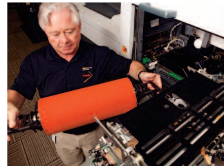
Austausch der Fixierwalze, um zum Beispiel eine andere Fixierwalze für den Matteeffekt einzusetzen.
