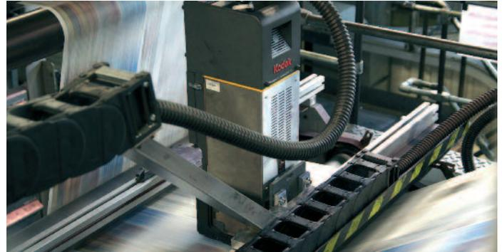
Erhebliche Fortschritte erzielte Kodak bei seinen Eindruckköpfen. Mit dem Prosper S30 werden beim Axel-Springer-Verlag in Ahrensburg in einer Rotation Geschwindigkeiten von 13,2 m/s erreicht.
