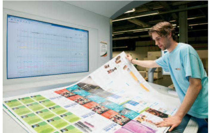
pier, wird dieses mit den Drucksachen anderer Kunden auf einer Sammelform belichtet und gedruckt. Mehrere Besteller teilen sich so die Kosten für die Druckform und den Druck. Selbst bei unterschiedlichen Auflagen ist ein solcher Auftrag für den jeweiligen Kunden immer günstiger als beim Einzelauftrag.
