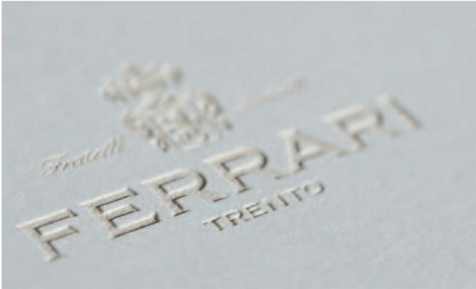
Eine Lasergravur (links eine Arbeit von Paperlux) trägt nur die oberste Schicht des Materials ab, ohne die Rückseite zu beschädigen.
