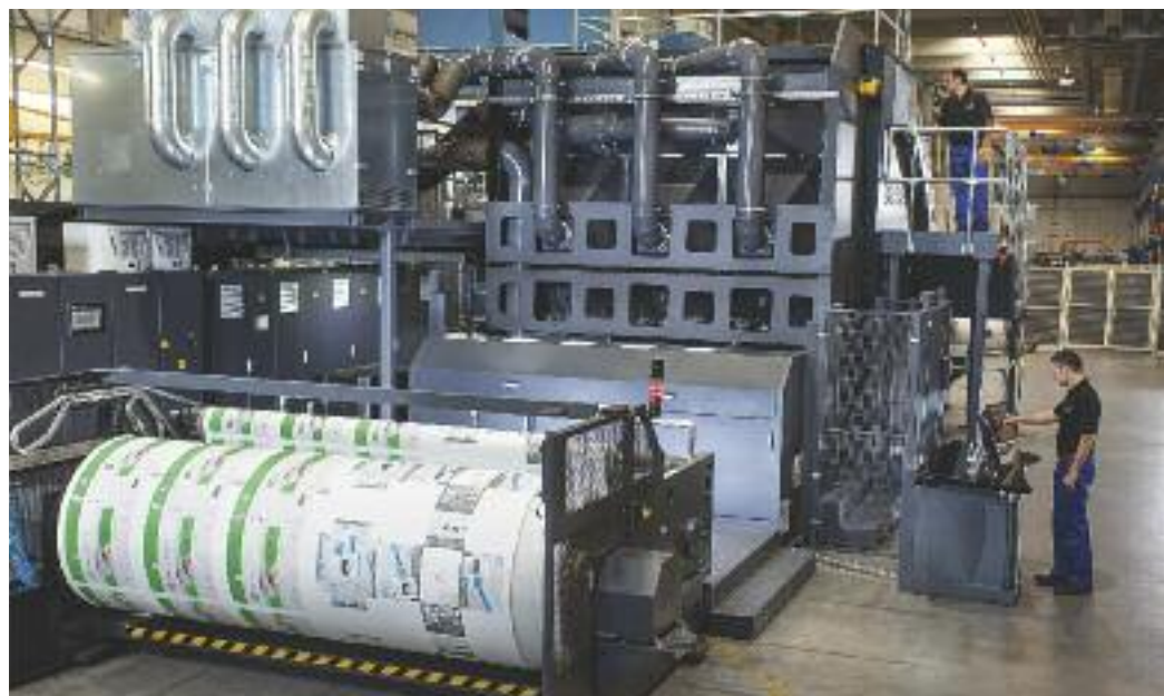
Mit 2,80 m Papierbahnbreite und einer digital bei Formaten und Auflagen flexibel bedruckbaren Fläche von über 30.000 m 2 /h ist die gemeinsam von HP und KBA-Digital & Web Solutions für den Wellpappen-Verpackungsmarkt entwickelte HP T1100S die grösste und leistungsstärkste Inkjet-Rotation auf dem Weltmarkt.
