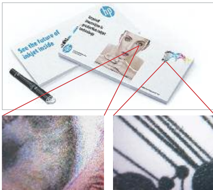
Ein Druckmuster des HDNA-Druckkopfs unter dem Mikroskop: Selbst bei 64-facher Vergrößerung lassen sich keine Raster- oder Sägezahn-Effekte entdecken.
