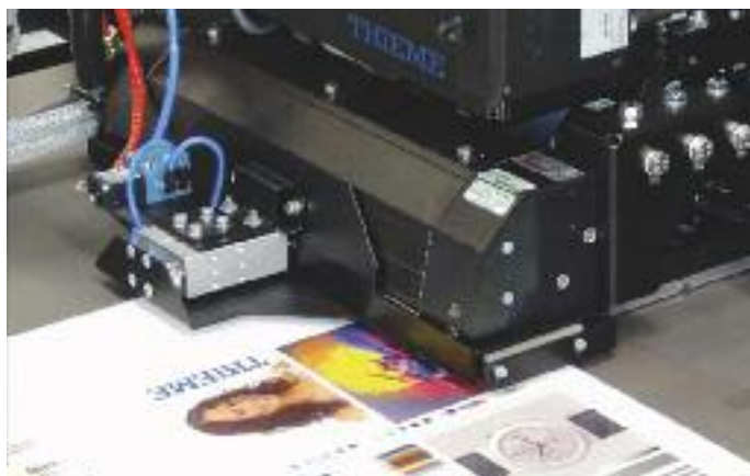
Das digitale Druckwerk lässt sich variabel mit Druckköpfen bestücken und bietet eine Auflösung von bis zu 1.600 x 2.160 dpi. Es können Tintensysteme verschiedener Hersteller und bei Bedarf auch hauseigene Tinten des Kunden verwendet werden.
