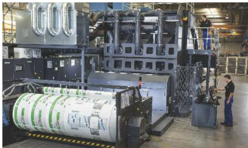
Mit 2,80 m Papierbahnbreite und einer digital bei Formaten und Auflagen flexibel bedruckbaren Fläche von über 30.000 m 2 /h ist die gemeinsam von HP und KBA-Digital & Web Solutions für den Wellpappen-Verpackungsmarkt entwickelte HP T1100S die größte und leistungsstärkste Inkjet-Rotation auf dem Weltmarkt.
