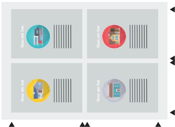
Der Rohbogen im Format 50 x 70 cm muss in einem klassischen Schneidesystem mindestens vier Mal beschnitten werden. Die weiteren Verarbeitungsschritte erfolgen dann üblicherweise an separaten Stationen. Auf einem Schneidetisch könnte der Bogen ohne Zwischentransporte komplett gefertigt werden.
