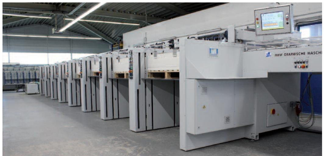
Mit acht Stationen und einer Länge von 18 Metern ist die MKW Rapid UT Gigant für Bogen bis maximal 102 x 133 cm ausgelegt und verarbeitet Substrate von 80 bis 1.000 g/m<sup>2</sup>.
