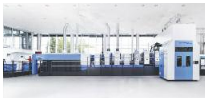
Gedruckt und veredelt wurde der Kalender auf einer Mittelformatanlage KBA Rapida 105 Pro mit Doppellack- und Kaltfolien-Ausstattung.
