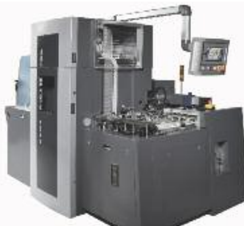
Schnelle Wertschöpfung: Der Wechsel vom Stanzen zum Veredeln mit Heißfolie ist an der Kama ProCut Foil schnell gemacht.
