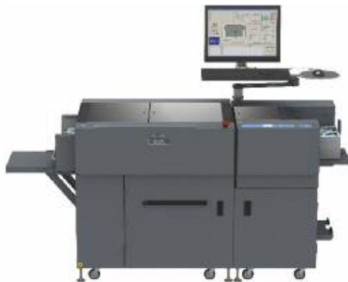
Ein typischer Vertreter der Multifinisher-Klasse: der FKS Duplo docucutter 745, der rillt, perforiert und schneidet.
