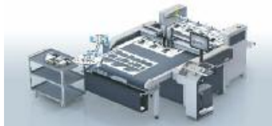
Der neue Roboter benötigt keinen geschützten Arbeitsbereich mehr und entlastet den Bediener von repetitiven und nicht wertschöpfenden Arbeiten.
