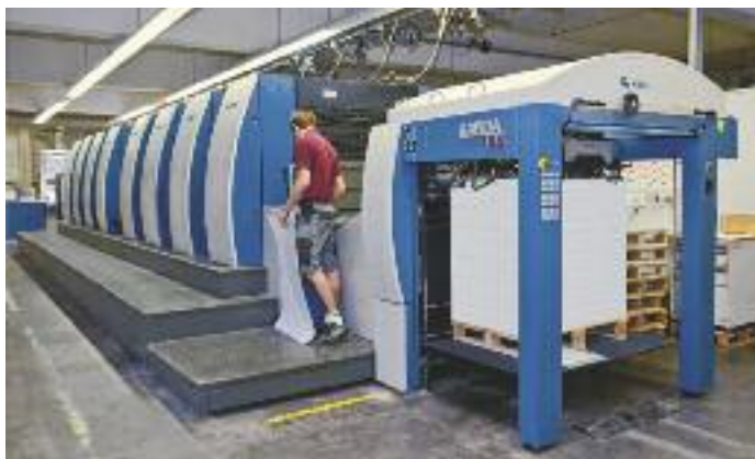
Die Rapida 106 wird als hochautomatisierte Wendemaschine im LED-UV-Druck produziert.
