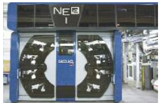
Der Druckturm der NEO XD LR ist für alle derzeit im CI-Flexo-druck gängigen Farb- und Trocknungssysteme vorbereitet.
