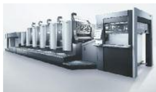
Bei der Speedmaster CX 102 wird der Transfer von Technologien der XL-Baureihen fortgesetzt. So ist sie nun mit einem vollautomatischen Ausleger-Nonstop-System erhältlich.
