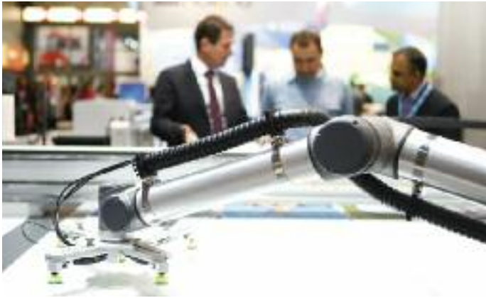
Rob, die swissQprint-Lösung für mannlosen Drucken, feierte auf der drupa Welt-premiere. Der kompakte Roboter ergänzt jeden swissQprint-Flachbettendrucker und bestückt ihn mit Bedruckstoffen.
