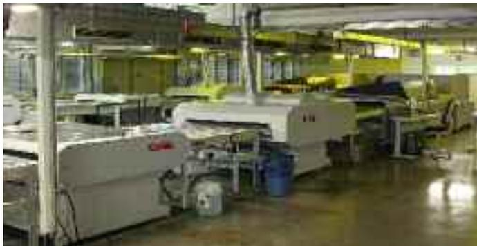
Die Bebilderung und Verarbeitung der Druckplatten auf den identisch konfigurierten CtP-Linien erfolgt weitgehend bedienerlos. Aufgrund der Stabilität des Verarbeitungsprozesses wird täglich nur eine Thermoplatte einer
