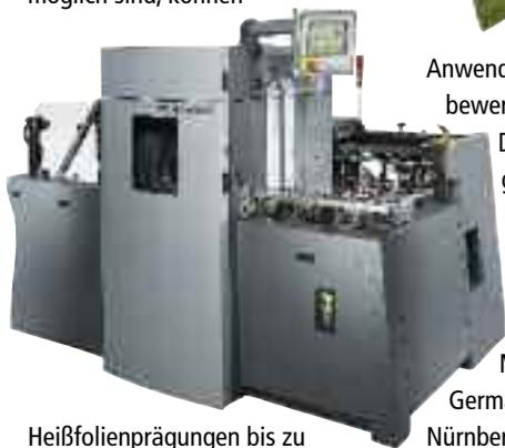
Heißfolienprägungen bis zu einer Größe von 510 x 360 mm durchgeführt werden. Die Aufheizzeit ist mit fünf bis zehn Minuten angegeben.
