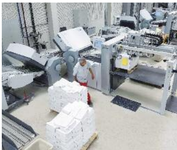
Mit zwei Falzanlagen Stahlfolder TX 96 mit PFX-Anleger wird fast das gesamte Signaturen-Volumen bewältigt.
