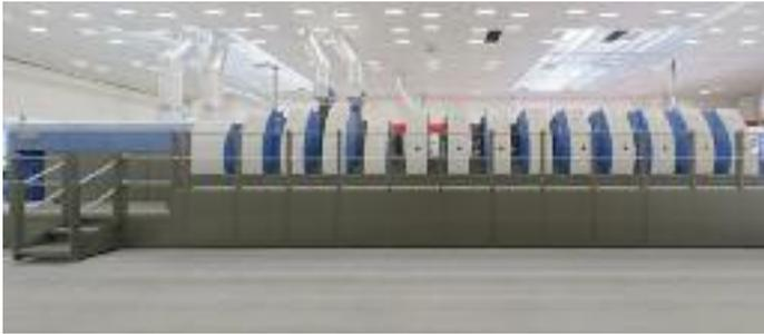
Mit bis zu 18.000 Bogen/h, neun Druckwerken und jeweils zwei Lack- und Trockentürmen vereint die hoch automatisierte Rapida 106 in Skalica höchste Produktivität mit optimalen Druck- und Veredelungsoptionen.
