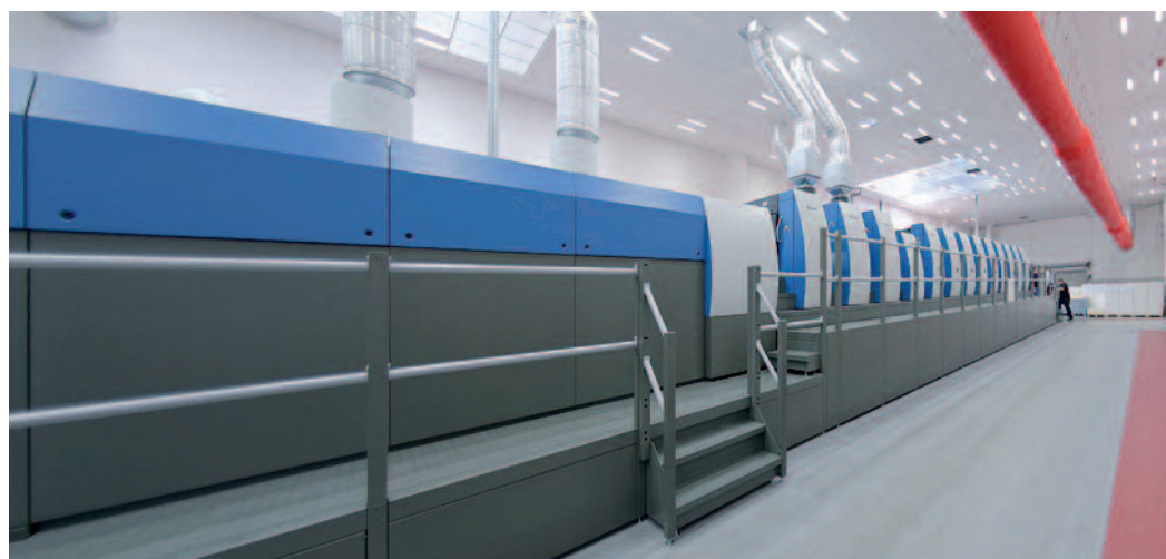
Beeindruckend und einzigartig in der Slowakei: die ca. 28 m lange 13-Werke-Maschine Rapida 106 bei Grafobal.
